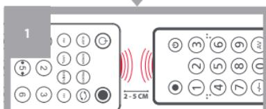
Umiestnite pôvodný diaľkový ovládač na plochý povrch čelom k ovládaču One For All.
