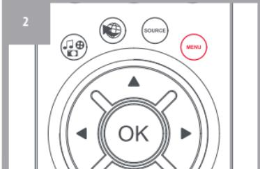
Namierte ovládač na televízor a podržte jedno z tlačidiel, ktoré nefunguje správne (napríklad  **MENU**).
